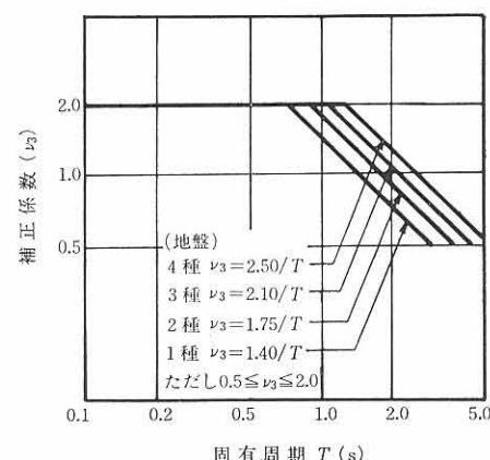
図-1 構造物の固有周期による補正係数  $v_3$
