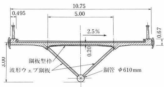
図-5 Maupré 橋の断面図
