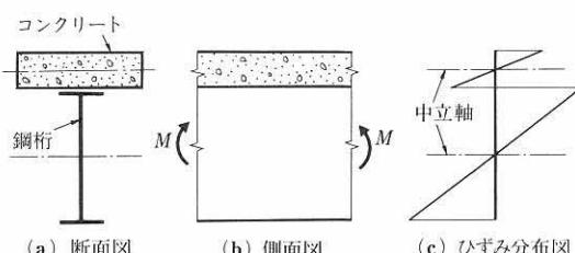
図-2 重ねばかりの断面とひずみ分布
