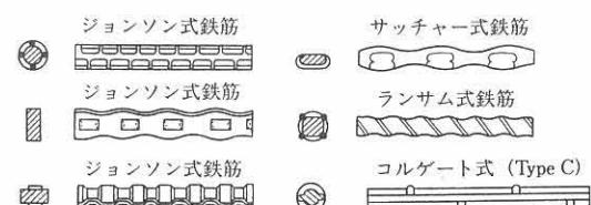
図-1 初期の異形鉄筋の例
